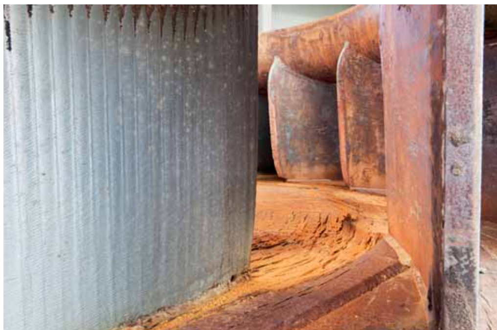
Крыльчатка с износом центрального диска
