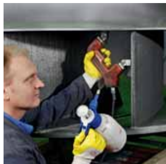
Выявление трещин (МР) на сварном шве после выполненного ремонта
