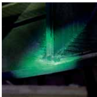
Выявление трещин (МР) на сварном шве после выполненного ремонта
