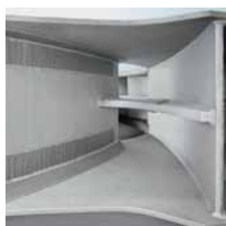
Комбинация различных защитных материалов на лопасти крыльчатки
