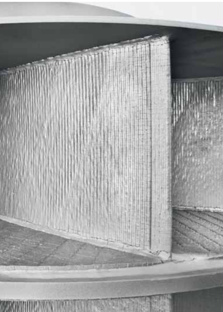
Специальная защита от износа на критически важных местах крыльчатки
